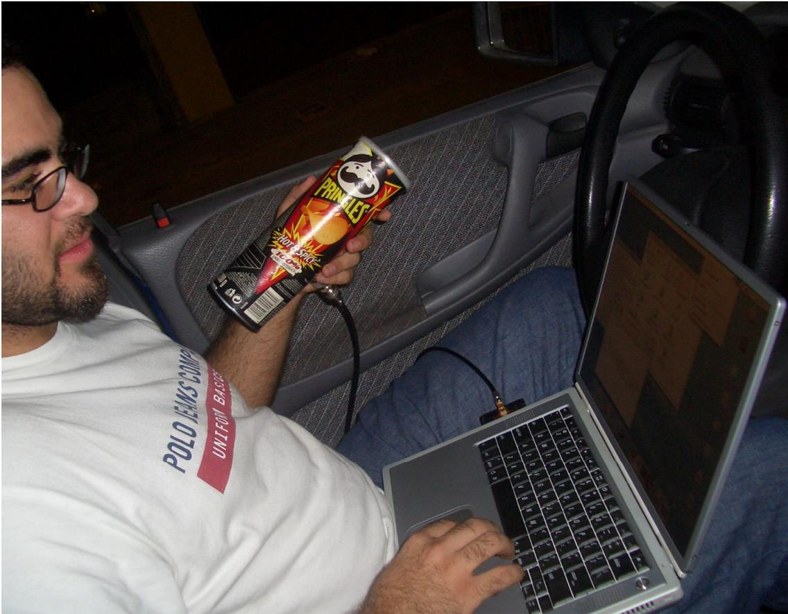
Utilización de antena externa *Pringles*
